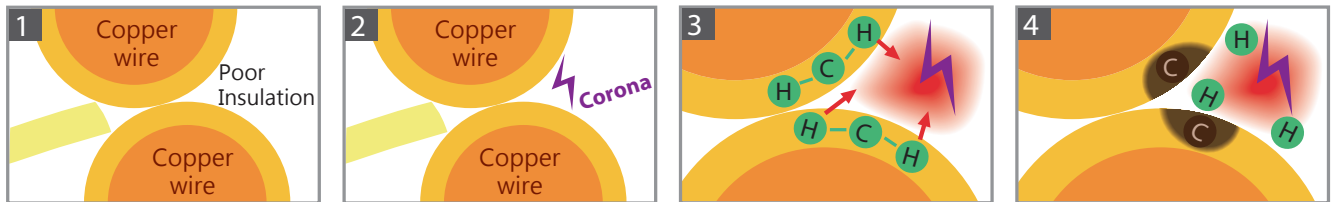
電暈放電造成絕緣層碳化
